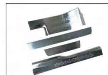
PW00396109 DOOR SILL(OUT) SIDE
